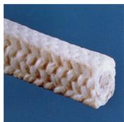
Κατασκευάζεται από ίνες φίμπεργκλας που έχουν αντίσταση σε χημικά. Κάθε ίνα φίμπεργκλας εμποτίζεται με ποιοτικό τεφλόν και λιπαντικό. Είναι μια συσκευασία ικανή ευρείας ποικιλίας των χρήσεων σε όλες εγκαταστάσεις. Μπορεί να χρησιμοποιηθεί στο ύδωρ, τον ατμό, τους διαλύτες, τα ήπια οξέα και τα αλκάλια στις αντλίες, τις ενώσεις επέκτασης, τους αναμίκτες σε 260°C.
